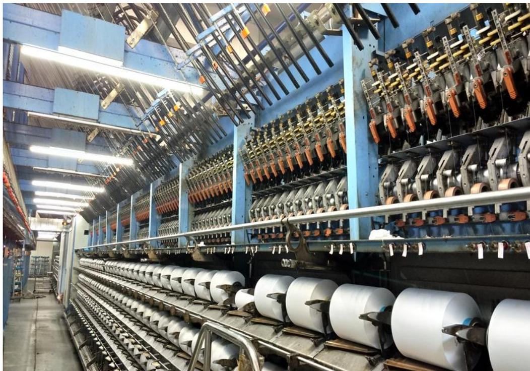
加弹机是一种可将涤纶(POY), 丙纶等无捻丝, 通过假捻变形加工成为具有中弹和低弹性能的弹力丝的一种纺织机械。
